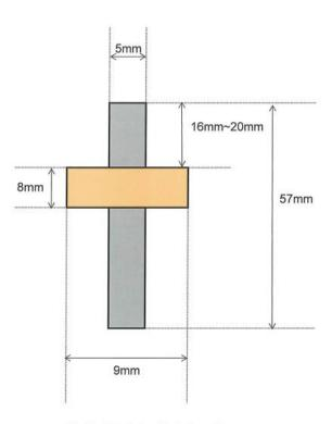
Al, Ni-plated Cu. Ni: 0.1mmT Sealant: PPaN
